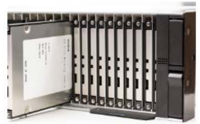
KIOXIA의 E3.S SSD 평가 샘플이 E3.S SSD 48개를 설치할 수 있는 2U-size rack의 서버 시제품에 장착됨. (이미지 사진)
